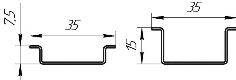
Рисунок 6. Профиль DIN-рейки типа TH-35
