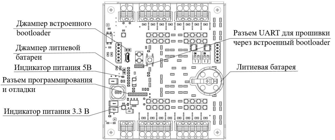
Рисунок 2. Внешний вид модуля, крышка снята.
