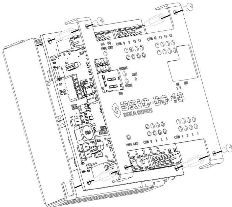
Рисунок 8. Схема разборки модуля
