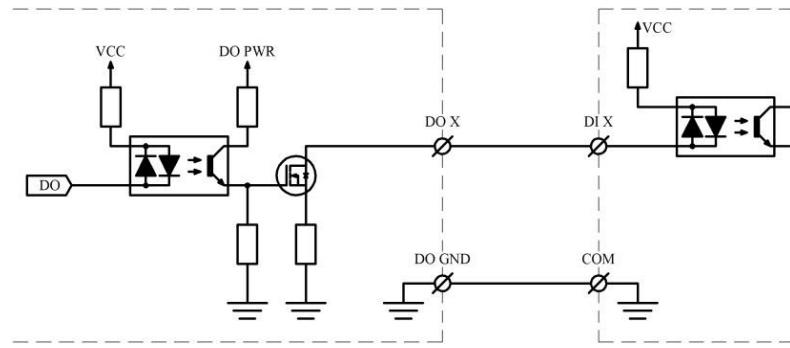
Рисунок 4. Подключение каналов DO в качестве выхода типа «сухой контакт»
