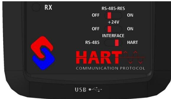
Рисунок 10 – Положение переключателей Преобразователя при подключении к устройствам с внешним источником питания
