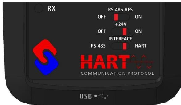
Рисунок 11 – Положение переключателей Преобразователя при подключении к устройствам с внутренним источником питания
